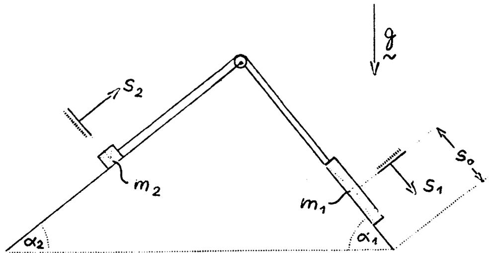
Zwei Massen  $m_1$  und  $m_2 = m_1/4$  sind durch ein masseloses, undehnbares Seil, das über eine masselose, reibungsfrei drehbar gelagerte Rolle geführt wird, miteinander verbunden. Der Reibungskoeffizient zwischen den Massen und der schiefen Ebene sei  $\mu$ . Die Massen  $m_1$  und  $m_2$  befinden sich anfangs für  $s_1 = s_2 = 0$  in Ruhe und werden sodann losgelassen.
