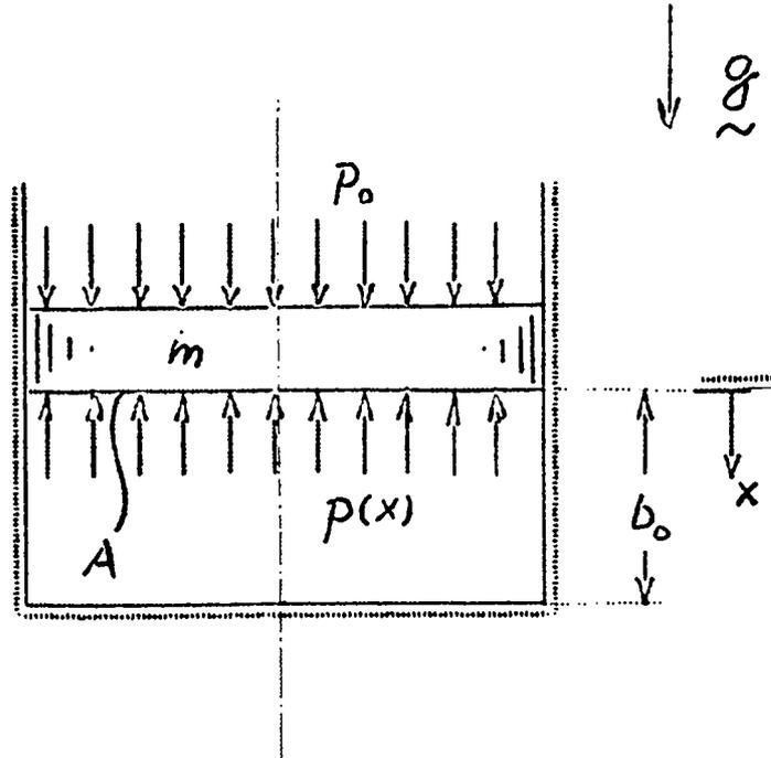
Ein Kolben der Masse  $m$  und der Querschnittsfläche  $A$  wird im Abstand  $b_0$  vom Zylinderboden ohne Anfangsgeschwindigkeit losgelassen. Während seiner Abwärtsbewegung ändert sich der Druck im Zylinder nach dem Gesetz  $p(x) = p_0 \frac{b_0}{b_0 - x}$ . Zwischen Zylinderwand und Kolben herrsche keine Reibung.
