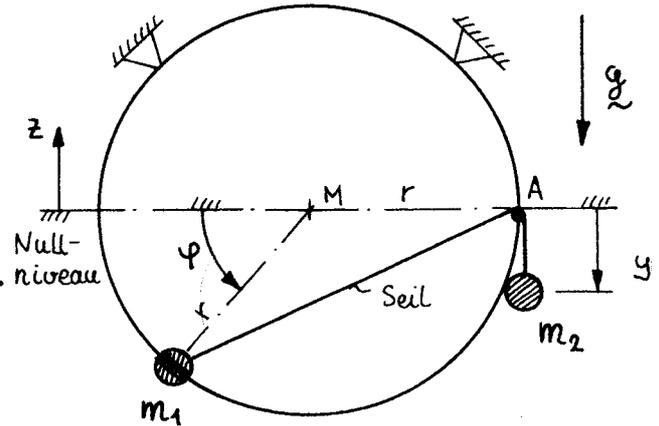
1. Man finde den **geometrischen Zusammenhang** von  $y$  und  $\varphi$  und daraus  $\dot{y}(\varphi, \dot{\varphi})$ .
